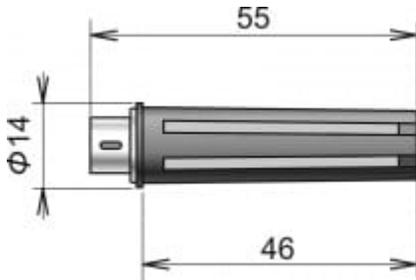
Sonde de mesure digital avec connecteur MiniDIN.
