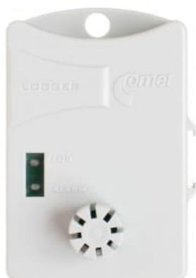
L'appareil enregistreur de données est conçu pour enregistrer la température et l'humidité. Les valeurs sont stockées dans une mémoire électronique non volatile. Le transfert de données vers l'ordinateur personnel pour une analyse ultérieure est effectué via une interface USB, RS232, GSM ou Ethernet à l'aide d'un adaptateur de communication approprié.
