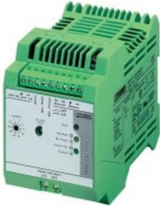
Alimentation de secours A6963, modèle MINI-DC-UPS / 24DC / 2 avec batterie A7963, modèle MINI-BAT / 24DC / 1.3AH, fabricant Phoenix Contact. L'alimentation est conçue pour être montée sur un rail DIN de 35 mm dans un boîtier d'enregistrement de données MP033 et MP034. Il contient deux modules - UPS et batterie.
