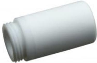
Capot de protection en téflon (PTFE) (couleur blanche) avec une résistance accrue aux projections d'eau, surface non absorbante. Capacité de filtrage 25 µm. Plage de température de -40 ° C à + 125 ° C. (fr)
