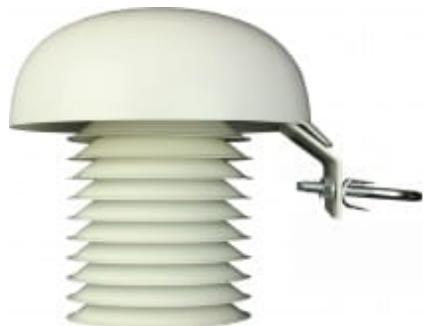
Nouvel écran météorologique multiplicateur pour les transmetteurs météorologiques. La protection contre les radiations et les intempéries est conçue pour la protection de tout capteur météo de 13 à 18 mm de diamètre.
