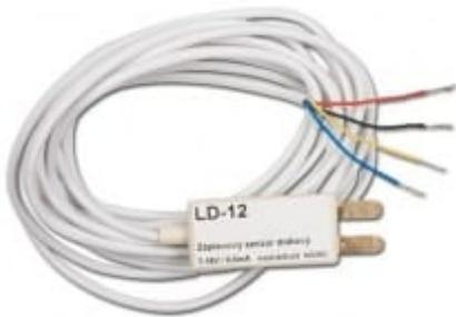
Détecteur de fuite d'eau, sortie à deux états, connectable aux régulateurs avec entrées binaires. Avec 3 mètres de câble. Alimenté par la sortie du régulateur 12Vdc.
