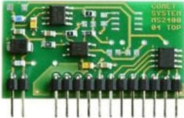
Entrée binaire pour contacts sans potentiel. Résistance maximale du contact fermé: 1000 ohms. Durée minimale d'enregistrement: 200ms. Isolé galvaniquement L'isolation galvanique n'est pas conçue comme protection de sécurité.
