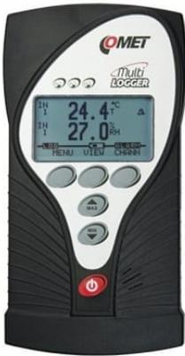
Enregistreur de données universel avec 4 entrées MiniDIN matérielles pour le raccordement des sondes de température et d'humidité. Multilogger peut être installé en permanence sur un réseau Ethernet ou fonctionner en tant que périphérique portable. Inclus est un certificat d'étalonnage traçable conforme à la norme EN ISO / IEC17025. Le Multilogger est un enregistreur de données à piles capable de mesurer et d'enregistrer les valeurs de capteurs et électriques à travers ses entrées.
