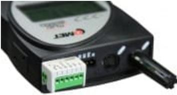
L'adaptateur MLP006 est conçu pour faciliter la connexion des signaux de tension et de courant aux entrées des multiloggers M13xx dans les cas où les émetteurs connectés nécessiteraient une alimentation provenant d'une source externe.
