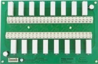
le module relais est conçu pour un montage dans un boîtier de protection adapté. Module de relais de sortie avec câble d'interconnexion. Il contient 16 alimentations relais 250V/8A avec contacts. Chaque relais peut être commandé, basé sur la création d'alarmes sur les différents canaux d'entrées par l'utilisateur via l'interface. Les relais de sortie sont conçus pour le contrôle des périphériques externes (commutation de chauffage, refroidissement, ventilation, alarme à distance, etc..).
