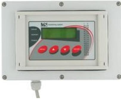
Terminal externe avec écran LCD alphanumérique à deux lignes, boutons de commande, 32 voyants d'alarme et indication d'alarme audio. Intégré dans un boîtier de protection IP54, incluant un câble de 2 m avec des terminaux couverts. Fonctions identiques au terminal intégré de l'enregistreur de données MS5D. Longueur maximale du câble vers l'enregistreur de données 50 m (fr)
