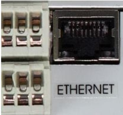
Interface LAN intégrée pour MS6D, connexion d'enregistreur de données MS6R au réseau Ethernet (Internet). Communication via: SNMP, SOAP, pages www, Modbus TCP. En cas de dépassement des limites, l'alarme est activée et les messages électroniques d'avertissement ou d'interruption SNMP sont envoyés aux adresses spécifiées.
