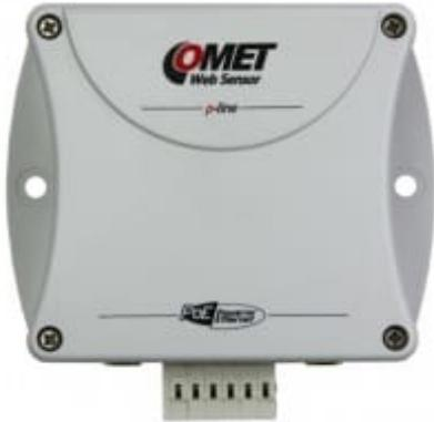
Capteur Web P-line avec PoE (fonction Power over Ethernet) pour mesurer la température, l'humidité relative et trois entrées binaires pour les signaux à deux états. Alarme à distance. L'appareil est équipé de deux connecteurs pour la connexion des sondes externes de température et d'humidité et de trois entrées binaires pour les signaux à deux états. Le contact sec ou le signal de tension à deux états peut être connecté à l'entrée binaire.
