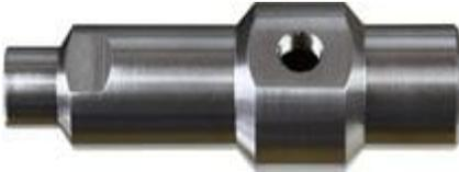
Chambre à air pour mesure d'air comprimé jusqu'à 25 bars - acier inoxydable DIN 1.4301 raccord d'entrée et de sortie - raccord de sonde d'humidité à filetage G1 / 8 - raccord fileté G1 / 2 non compris.
