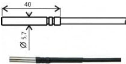
Sonde de température avec capteur Ni1000 / 6180 ppm.
