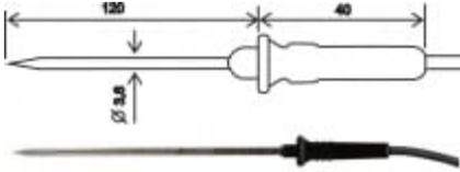
Sonde de température avec capteur Pt1000.
