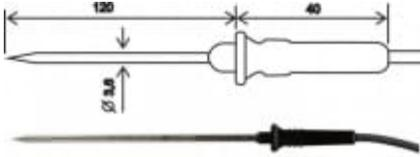
Sonde de température avec capteur Pt1000.
