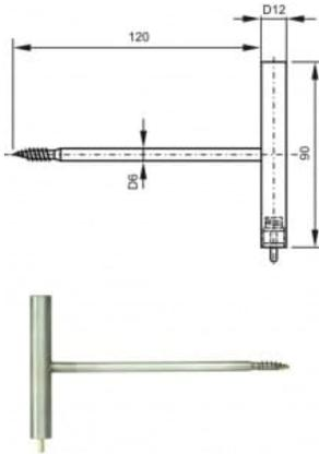
Sonde de température avec capteur Pt1000.
