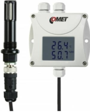
Humidité, transmetteur de température. Sonde T + RH en duralumin anodisé dur pour air comprimé jusqu'à 25 bars avec 1 m de câble. Des longueurs de câble de 2m ou 4m sont disponibles en option. Utilisation extérieure et intérieure.
