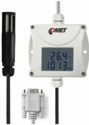
Transmetteur de température, humidité et pression atmosphérique. Utilisation extérieure et intérieure. Humidité, sonde de température sur un câble. Les valeurs mesurées sont également converties en une autre interprétation de l'humidité: température du point de rosée, humidité absolue, humidité spécifique, rapport de mélange, enthalpie spécifique. Capteur de pression intégré.
