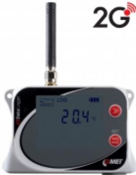
L'enregistreur de données est conçu pour l'enregistrement de la température. En cas de dépassement des limites définies, les messages SMS et JSON peuvent être envoyés via une connexion de données GPRS. Il est possible de définir l'envoi régulier de messages JSON à la base de données COMET, l'intervalle d'envoi est réglable. L'enregistrement est effectué dans une mémoire électronique non volatile. Les données peuvent être transférées sur un PC via USB-C.
