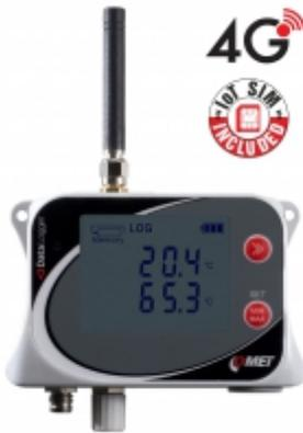
L'appareil est conçu pour enregistrer la température de 2 sondes Pt1000 externes. En cas de dépassement des limites définies, les messages SMS et JSON peuvent être envoyés via une connexion de données 4G. Il est possible de définir l'envoi régulier de messages JSON à la base de données COMET, l'intervalle d'envoi est réglable. L'enregistrement est effectué dans une mémoire électronique non volatile. Les données peuvent être transférées sur un PC via USB-C.
