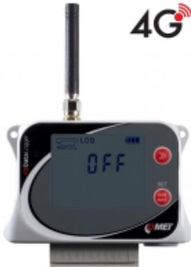
L'enregistreur de données est conçu pour enregistrer à partir d'une entrée d'impulsion et à deux états. En cas de dépassement des limites définies, les messages SMS et JSON peuvent être envoyés via une connexion de données 4G. Il est possible de définir l'envoi régulier de messages JSON à la base de données COMET, l'intervalle d'envoi est réglable. L'enregistrement est effectué dans une mémoire électronique non volatile. Les données peuvent être transférées sur un PC via USB-C.
