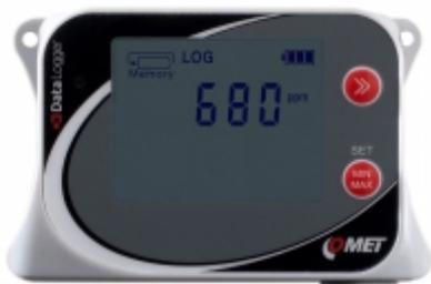
Le Datalogger est conçu pour enregistrer la CO2. En cas de dépassement des limites définies, les alarmes sont signalées par une LED, un écran LCD et de manière acoustique par un bip sonore intégré.
