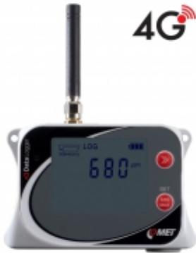
L'enregistreur de données GSM est conçu pour enregistrer la CO<sub>2</sub>. En cas de dépassement des limites définies, les messages SMS et JSON peuvent être envoyés via une connexion de données GPRS. Il est possible de définir l'envoi régulier de messages JSON à la base de données COMET, l'intervalle d'envoi est réglable. L'enregistrement est effectué dans une mémoire électronique non volatile. Les données peuvent être transférées sur un PC via USB-C.
