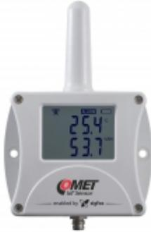
L'instrument mesure la température et l'humidité de la sonde externe. Il présente une conception simple et compacte et est positionné directement dans la zone mesurée. Les valeurs mesurées sont affichées à l'écran et sont envoyées régulièrement, dans un intervalle de temps ajustable (10 min à 24 h), par transmission radio de Sigfox à COMET Cloud.
